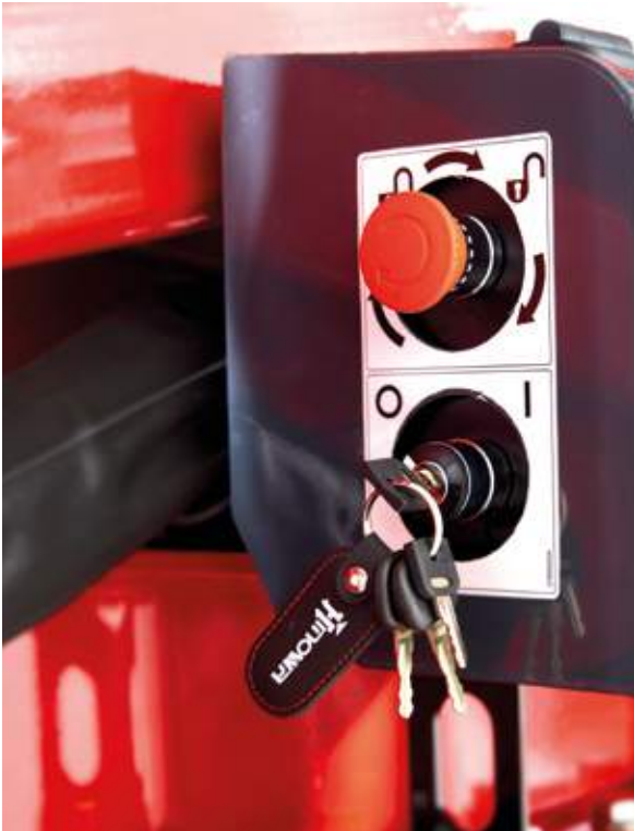
▼ Simplified ignition system with a single key . Vereinfachtes Anlassen über Schlüsselstartsystem.
